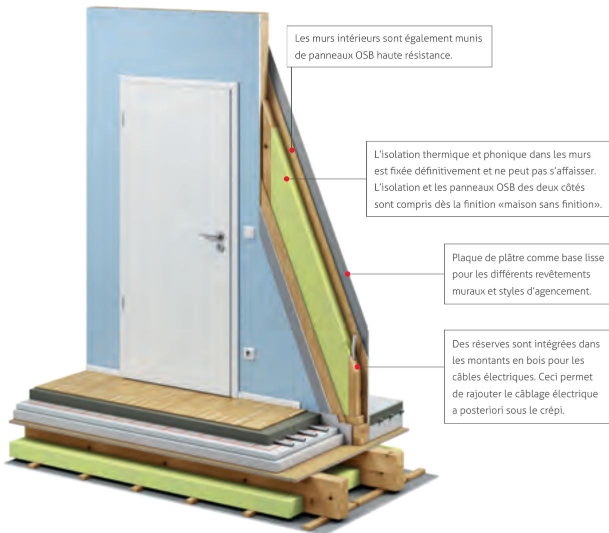
Les cloisons de séparation du bâtiment et de l'appartement, les murs de l'étage et des combles ainsi que les murs dont la hauteur sous plafond (env. 2,50 m) est différente de la normale peuvent être exécutés différemment des murs extérieurs, de pignon et cloisons intérieures tel que décrit.
